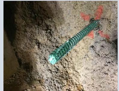
自穿孔GRPロックボルト末端部の破損状況
