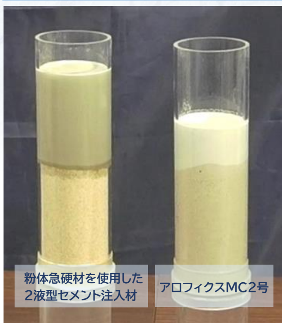
■浸透性比較 | 豊浦砂に対する自然流下試験
