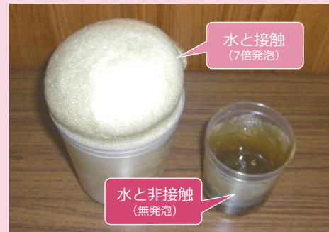
② 帯水層における湧水との反応により水脈を閉塞してトンネルへの引き込み水量を減少し、最終的に無発泡体の防水ゾーンを形成することにより、減水・止水する
