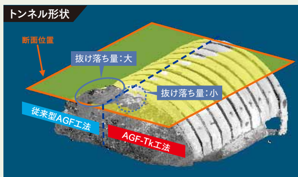
三次元レーザースキャナによる形状確認
