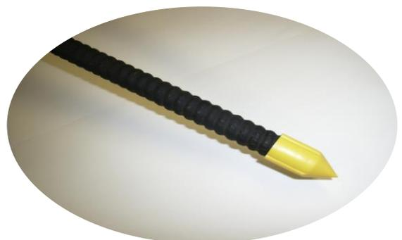
SPINMAXは、注入式フォアポーリングの芯材であるP Uボルトより大きな引張強度を有します。また、P Uボルトの約1/3と軽量であるため、作業性と作業の安全性が向上します。ローテーションビットと組み合わせることで、自穿孔タイプとしても使用できます。
