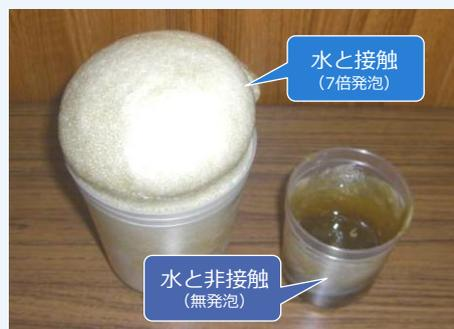
② 帯水層における湧水との反応により水脈を閉塞してトンネルへの引き込み水量を減少し、最終的に無発泡体の防水ゾーンを形成することにより、減水・止水する
