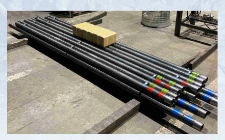
パノラマタフライトは従来のパノラマ 鋼管を薄肉の高張力鋼とすることで、 品質向上、軽量化による施工性向上、 安全性向上、生産性向上(工期短縮) を目的とした次世代小口径鋼管です。
